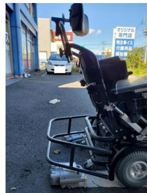
フロントのフットガードを短くし、リアガードをプレー時のリクライニングの角度に合わせ、ヘッドレストを3.5 cm内側に修理した例です。（まだ完成していませんが、全長は129.4 cm以内になります。）
